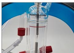
» Remplissage de la chaudière jusqu'au trait et allumage du chauffage
