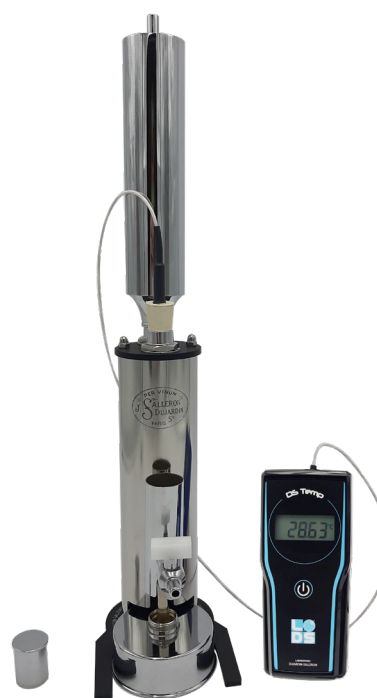
Utilisation du DS TEMP avec l'ébulliomètre traditionnel
