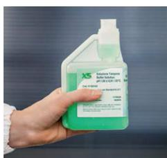
Ouvrir le flacon et presser le réservoir pour remplir le compartiment de dosage
