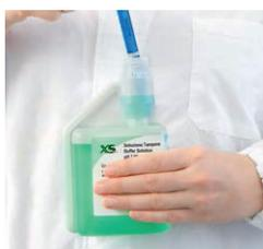
Tremper l'électrode directement dans le compartiment pour la calibration
